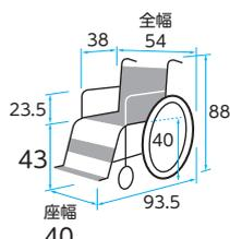
スリム&軽量を実現。左右独立の背張り調整可能な立体スリングシートを採用し、側彎の方にも対応可能です。
